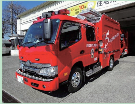
車名：日野（デュトロ） 全長：587cm 全高：285cm 駆動方式：2WD/AT ポンプ級別：A-2 配置先：相原分署
