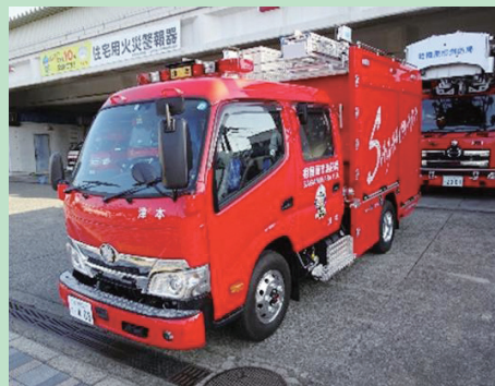
車名：日野（デュトロ） 全長：575cm 全高：279cm 駆動方式：4WD/MT 水槽容量：600L 配置先：津久井本署
