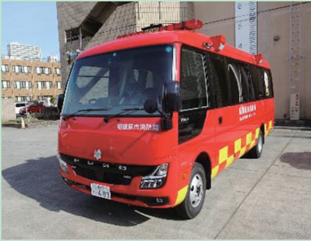
車名：三菱（ローザ） 全長：702cm 全高：281cm 駆動方式：4WD/AT 乗車定員：21人 配置先：南本署
