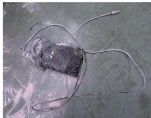
モバイルバッテリーの損傷による出火なども！
