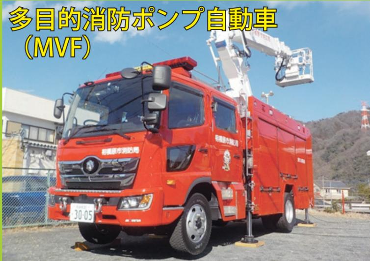
水と空気を圧縮して消火泡を放射する装置 (CAFS) を搭載しています。13.7mのブーム (屈折はしご) がついた特殊車両。
