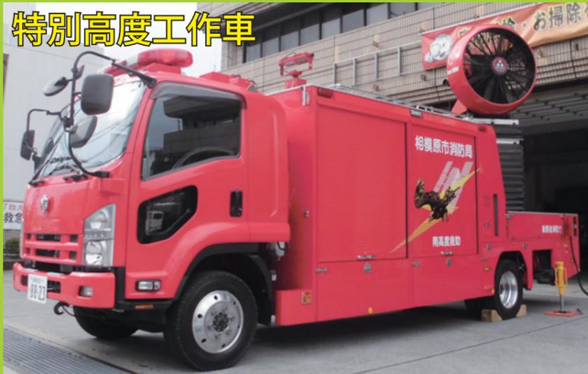
南消防署高度救助隊が運用する車両。大型のブローアにより、トンネル火災現場などで排煙を行います。
